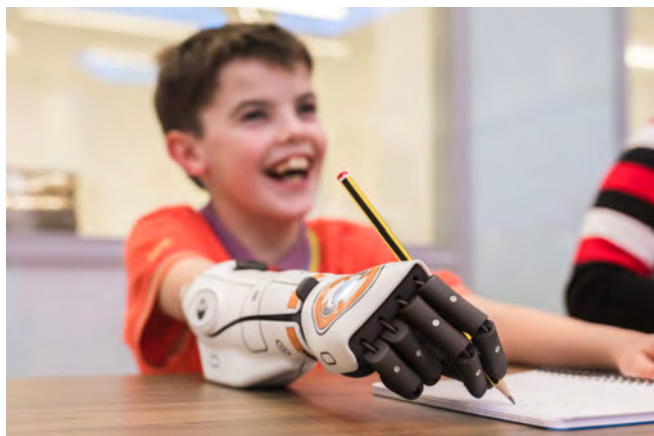
Кэмерон использует схват «Трехточечный Закрытый» (Tripod B) на протезной кисти с 3 электро-приводами (размер S92), для удержания карандаша.
